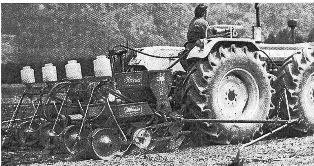
Fig. 9: Cette combinaison moderne de plusieurs matériels permet d'effectuer simultanément (en un seul passage) l'épandage d'engrais, le semage de maïs, la distribution de granulés et un traitement par pulvérisation.
