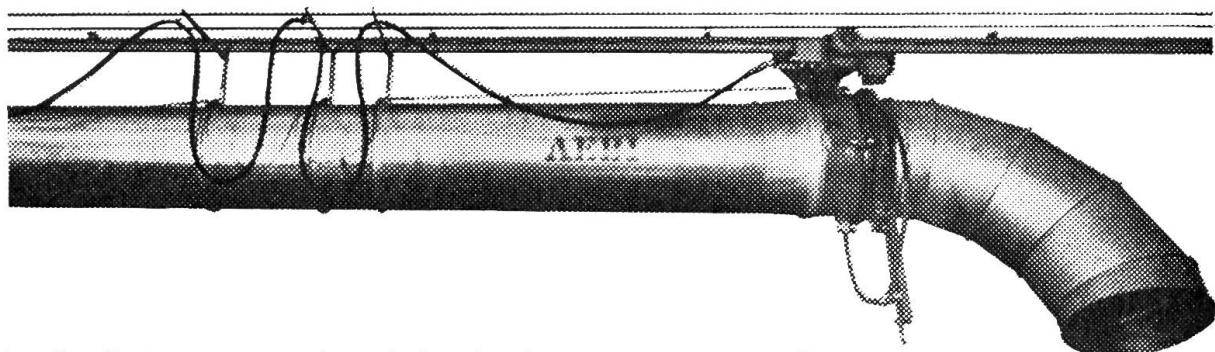
Le distributeur automatique Fe-Gu commandé par moteur électrique. Pour tuyauteries de 400 et 500 mm Ø. Surface de déchargement jusqu'à 7.00 m de profondeur et 12.00 m de largeur.
