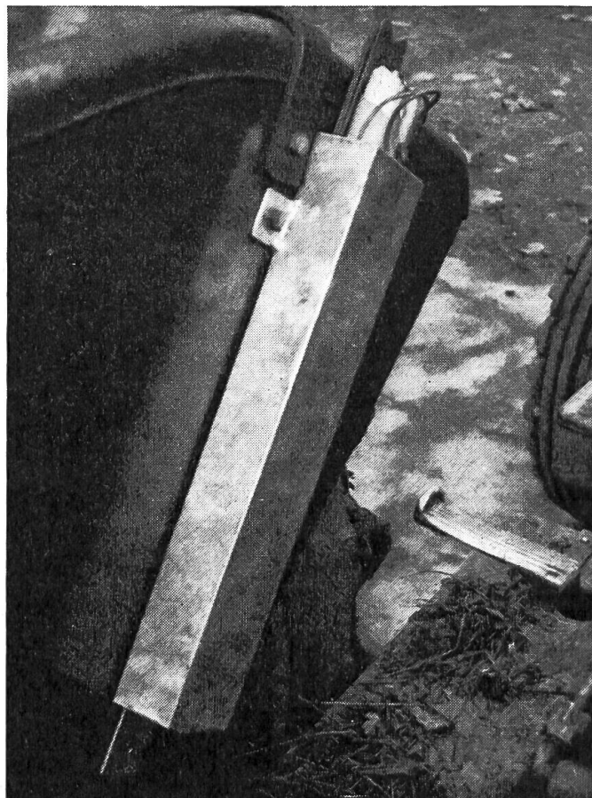
Fig. 2: Etui métallique à fixer sur la machine de traction. Il contient le triangle de panne et le signal à suspendre, tous deux obligatoires. Ainsi rangés, ces signaux se trouvent toujours à portée de la main.
