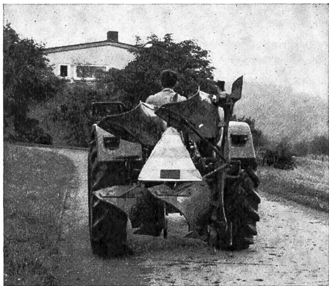
Fig. 1: Signal en forme de pyramide exigé par l'ordonnance fédérale OCE.
