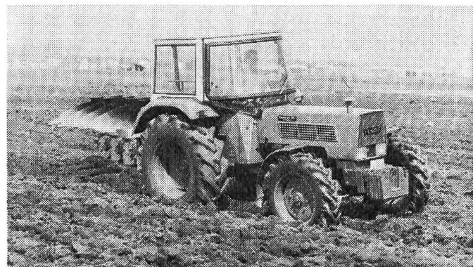
L'équipement de base comporte une direction assistée hydrauliquement et des pneus de grand format à l'avant et à l'arrière (7.50-20 et 14-34) en tant qu'organes de série.
