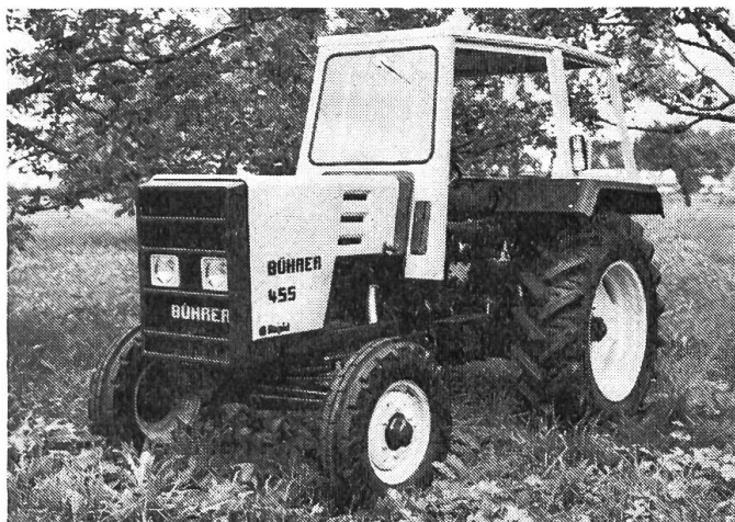
Fig. 2: Le nouveau tracteur Bührer 455 muni d'un moteur de 55 ch et d'un toit-abri constitué d'un arceau de sécurité, d'un pare-brise et d'une toiture.
