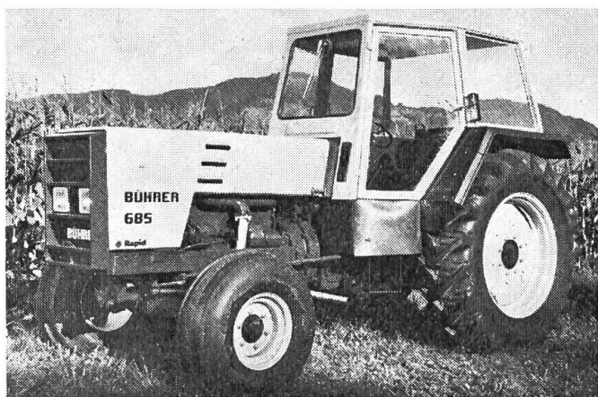
Fig. 1: Le nouveau tracteur Bührer 685 pourvu d'un moteur de 85 ch et d'une cabine de sécurité complètement équipée.
