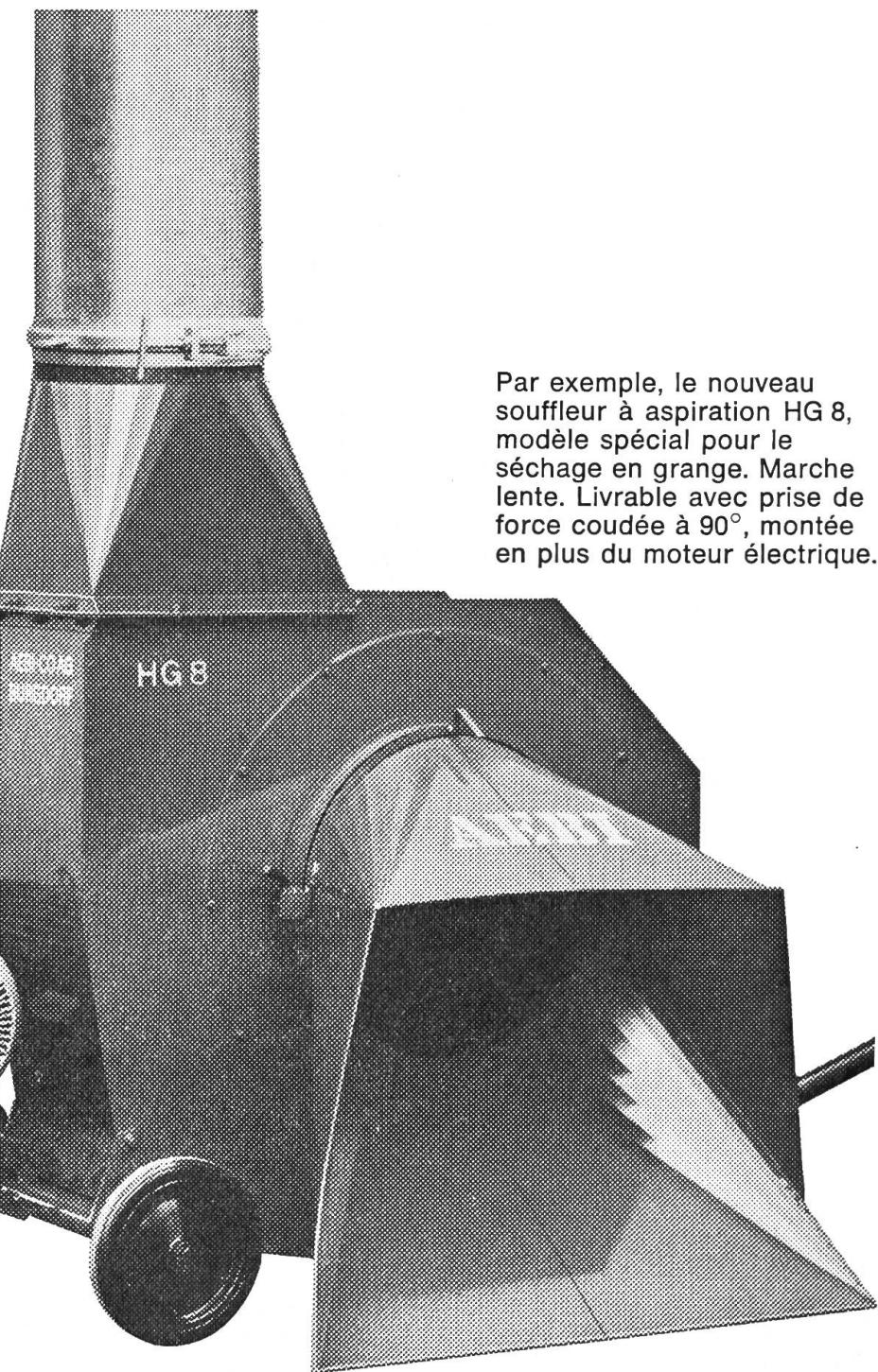
Par exemple, le nouveau souffleur à aspiration HG 8, modèle spécial pour le séchage en grange. Marche lente. Livrable avec prise de force coudée à 90°, montée en plus du moteur électrique.
