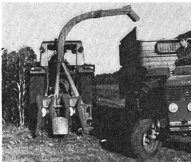
Fig. 2: La récolteuse de maïs-fourrage portée Maïswolf Duplex accouplée à l'arrière du tracteur.
