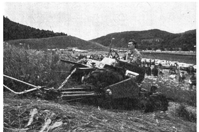
Fig. 6: Faucheuse automotrice polyvalente à 4 roues dont la barre de coupe frontale à double lame est entraînée mécaniquement.
