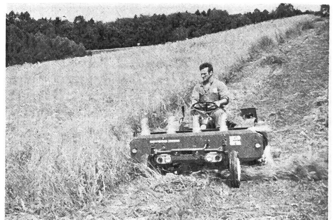
Fig. 7: Cette machine est capable d'exécuter simultanément la coupe et l'épandage du fourrage.
