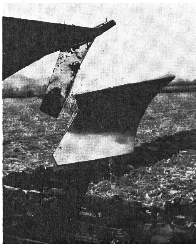
Fig. 7: Coudre combiné avec le soc (soc-coudre)
