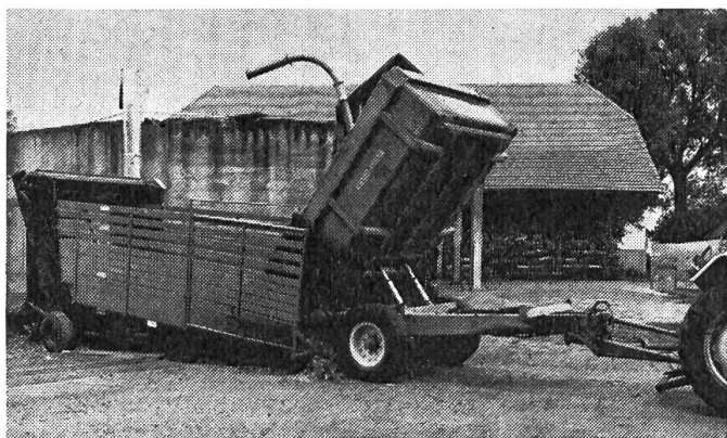
Fig. 1: Il est possible de faire basculer des charges complètes dans la déchargeuse automatique et de libérer immédiatement le véhicule de transport.
