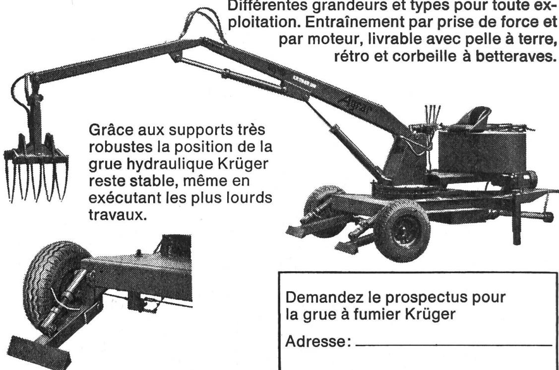
Grâce aux supports très robustes la position de la grue hydraulique Krüger reste stable, même en exécutant les plus lourds travaux.
