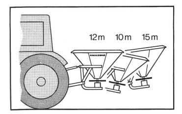
Les instructions de service indiquent la façon de procéder (allongement ou accourcissement de la bielle de relevage supérieure) pour obtenir la largeur de travail voulue selon l'engrais à épandre. Le fertilisant utilisé ici est un mélange de nitrate de chaux et de nitrate d'ammoniaque.
