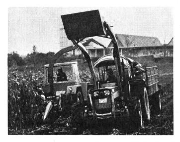
A gauche, le nouveau tracteur lourd KRAMER à 4 roues motrices d'égal diamètre travaillant en va-etvient (plus de virages!), qui représente une solution d'avenir. Il est équipé ici d'une récolteuse de maïsfourrage portée et se déplace en marche arrière (poussée). Sa monœuvrabilité est inégalée.
