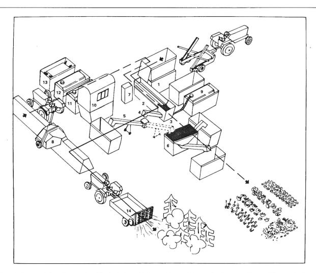
Représentation schématique de l'installation Fahr pour le traitement des ordures ménagères.
