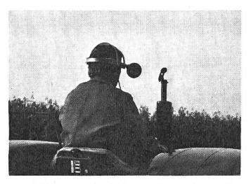
Fig. 2: Mesurage du bruit au niveau des oreilles du conducteur d'un tracteur au moyen d'un microphone fixé sur une monture.
