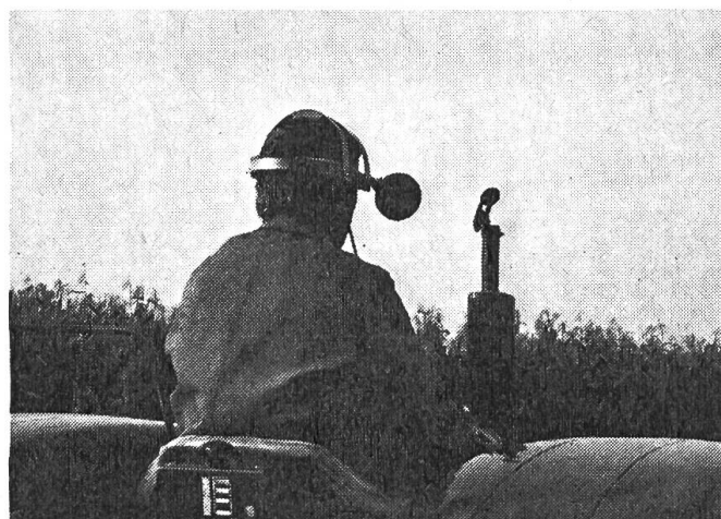
Fig. 2: Mesurage du bruit au niveau des oreilles du conducteur d'un tracteur au moyen d'un microphone fixé sur une monture.
