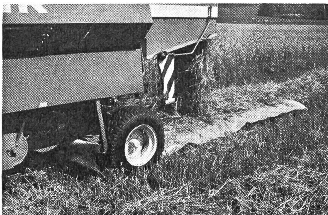
Fig. 6: Détermination des pertes de grain, provoquées par tous les organes qui suivent le tablier de coupe, lors d'essais effectués à la FAT avec une moissonneuse-batteuse.
