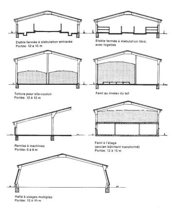
Fig. 5: Types de constructions du système à cadres rigides.
