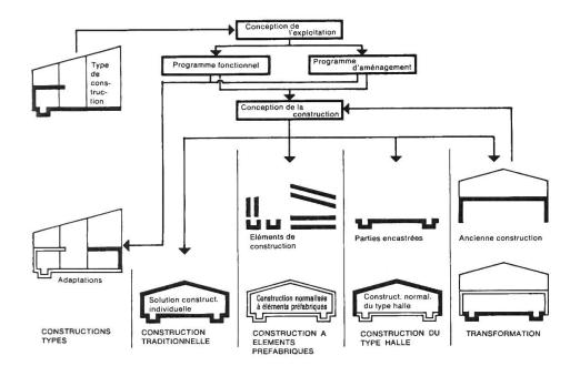
Fig. 3: Méthodes applicables pour l'édification de bátiments d'exploitation agricoles.
