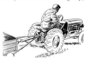
Fig. 7: Aspect du système hydromécanique de freinage Tétrax. Il fait de tout frein mécanique de remorque un frein principal pendant la marche, un frein de stationnement et un frein de sécurité (au cas où la remorque se décrocherait). Etant donné que tous les tracteurs agricoles sont désormais pourvus d'un dispositif de relevage hydraulique, il semble tout naturel que ce dispositif soit également utilisé pour le freinage.
