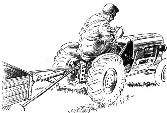
Fig. 7: Aspect du système hydromécanique de freinage Tétrax. Il fait de tout frein mécanique de remorque un frein principal pendant la marche, un frein de stationnement et un frein de sécurité (au cas où la remorque se décrocherait). Etant donné que tous les tracteurs agricoles sont désormais pourvus d'un dispositif de relevage hydraulique, il semble tout naturel que ce dispositif soit également utilisé pour le freinage.
