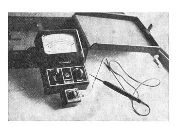
Fig. 3c: Thermomètre tâteur de précision
