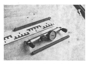
Fig. 3b: Dilatomètre mécanique dit déformètre
