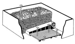
Fig. 7 et Fig. 8: Représentation schématique d'installations de postséchage sous toit à planchers à claire-voie latéraux, avec et sans bouchons amovibles, où la ventilation du fourrage s'effectue dans le sens vertical.
