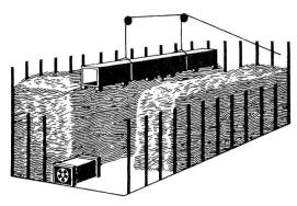
Fig. 10: Type d'installation avec gaine d'amenée d'air faisant également office d'obturateur amovible qu'on relève à l'aide de câbles.
