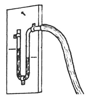
Fig. 2: Manomètre constitué d'un tube de verre transparent recourbé en U pour le mesurage de la pression de l'air régnant dans une installation destinée au séchage complémentaire du foin en grange. Il est relié à la gaine de ventilation centrale par un tuyau souple.
