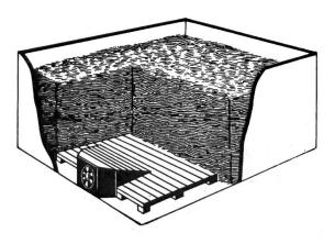
Fig. 9: Type d'installation sans gaine centrale avec ventilation directe sous le plancher à claire-voie.
