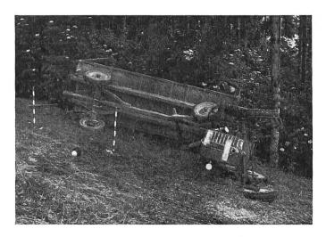
Fig. 3: Même avec son chargement léger — des siccateurs — cette remorque a aussi provoqué le dérapage et le capotage du tracteur.
