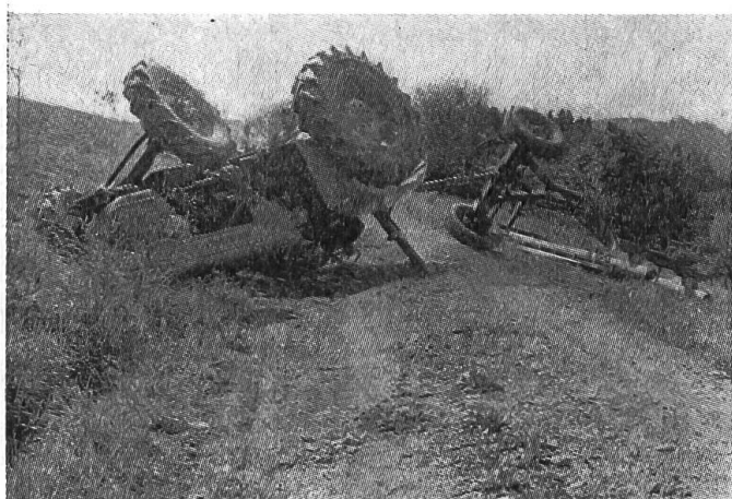
Fig. 2: Une remorque vide a fait déraiper le tracteur — il s'agit pourtant d'une machine à quatre roues motrices — sur un accident de terrain.
