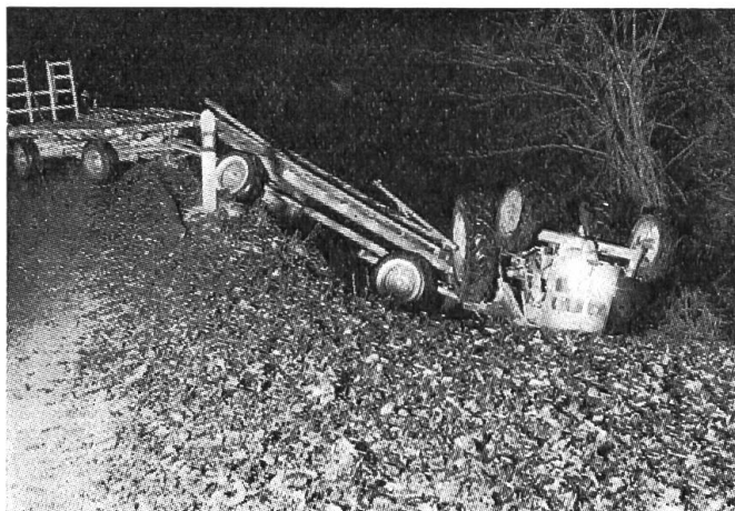
Fig. 1: En dérapant, ces deux remorques vides ont exercé une forte poussée sur le tracteur et provoqué ainsi son renversement.
