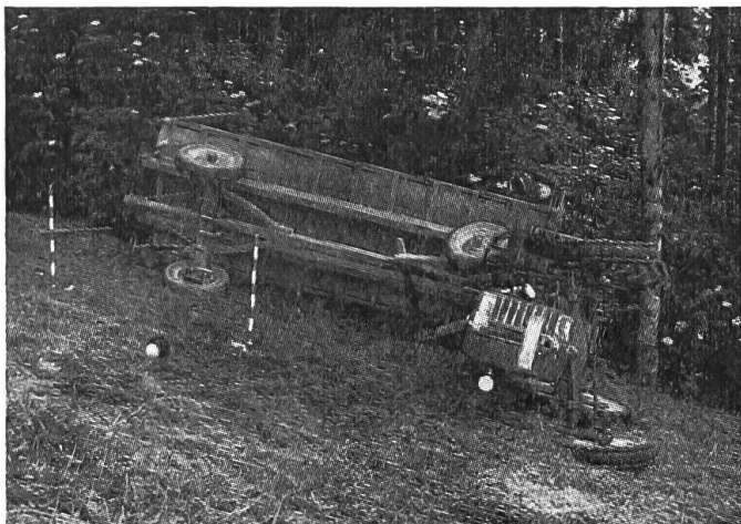
Fig. 3: Même avec son chargement léger — des siccateurs — cette remorque a aussi provoqué le dérapage et le capotage du tracteur.
