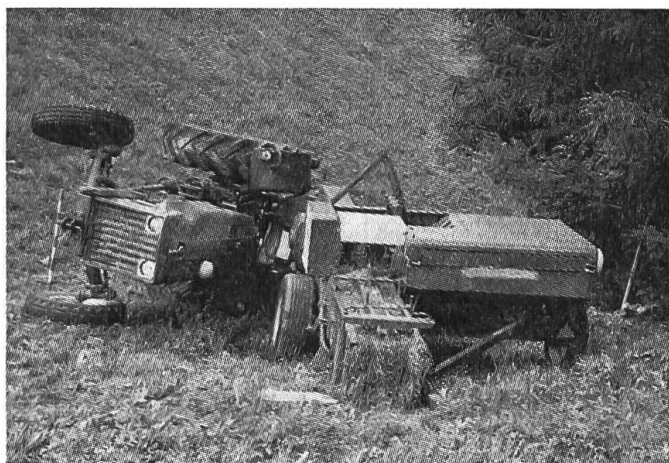
Fig. 4: Ce ne sont pas seulement les ramasseuses-presses de type lourd — comme ici — qui peuvent causer le dérapage et le renversement du tracteur sur les terrains en pente, mais aussi les ramasseuses-presses de type léger.
