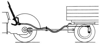
Fig. 5: Un freinage progressif depuis le poste de conduite du tracteur peut empêcher dans une large mesure que la remorque exerce une poussée sur la machine de traction et la fasse basculer.
