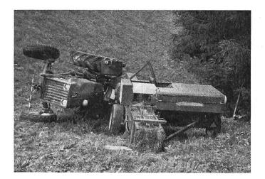
Fig. 4: Ce ne sont pas seulement les ramasseusespresses de type lourd — comme ici — qui peuvent causer le dérapage et le renversement du tracteur sur les terrains en pente, mais aussi les ramasseusespresses de type léger.
