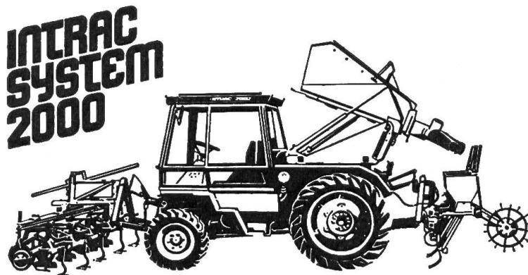
Un authentique système «auto-moteur» · Avec une gamme d'outils intégrés pour combinaison de plusieurs opérations en un seul passage · 3 zones d'accouplement (à l'avant, au centre, à l'arrière) · Dispositifs hydrauliques munis du DEUTZ-HITCH, à l'avant et à l'arrière · Prises de force autonomes à l'avant et à l'arrière · Changements d'outils sans avoir à quitter son siège · En un mot, la machine parfaite pour l'exploitation «auto-moteur» ·
