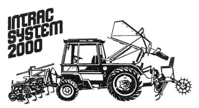
Un authentique système «auto-moteur» · Avec une gamme d'outils intégrés pour combinaison de plusieurs opérations en un seul passage · 3 zones d'accouplement (à l'avant, au centre, à l'arrière) · Dispositifs hydrauliques munis du DEUTZ-HITCH, à l'avant et à l'arrière · Prises de force autonomes à l'avant et à l'arrière · Changements d'outils sans avoir à quitter son siège · En un mot, la machine parfaite pour l'exploitation «auto-moteur» ·
