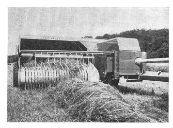
Fig. 2: Aspect de la ramasseuse-presse John Deere à haute densité du modèle 346. Du fait de la capacité de travail toujours plus grande des moissonneuses-batteuses, les andains de paille deviennent aussi plus volumineux. C'est la raison pour laquelle cette nouvelle ramasseuse-presse a été dotée d'un tambour ramasseur d'une largeur de 1 m 80.
