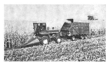
Fig. 1: Les nouvelles récolteuses autotractées John Deere à fourrages — modèles 5200 et 5400 — constituent des exécutions identiques sauf en ce qui concerne le moteur. Les moteurs d'entraînement sont des diesels avec alimentation sous pression. Leur puissance est respectivement de 160 et 212 ch. Le dispositif récolteur à maïs, de même que le dispositif cueilleur d'épis de maïs, ne diffèrent pas des types montés jusqu'à maintenant sur les autres modèles.
