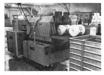
III. 5: Automate permettant de comprimer les bobines en les enveloppant de papier transparent, de les étiqueter et de les disposer dans des boîtes en carton.
