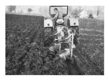
Fig. 2: La superficie travaillée par heure ne peut pas s'accroître dans une mesure correspondant à l'augmentation de la puissance du tracteur. C'est pourqui il vaut mieux employer une charrue bisoc que de rouler plus vite avec une charrue monosoc.
