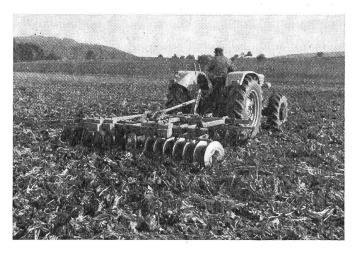
Fig. 8: Le pulvériseur à disques continue à jouer un rôle de premier plan pour la préparation mécanique du sol (exécution des façons superficielles).
