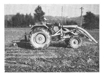
Fig. 6: Une charrue taupe pour le drainage en galeries (charrue draineuse) est l'instrument qui convient le mieux pour évacuer l'eau excédentaire d'un sous-sol ayant été comprimé par les roues des véhicules et machines agricoles.
