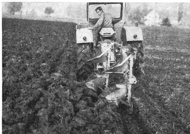
Fig. 2: La superficie travaillée par heure ne peut pas s'accroître dans une mesure correspondant à l'augmentation de la puissance du tracteur. C'est pourquoi il vaut mieux employer une charrue bisoc que de rouler plus vite avec une charrue monosoc.
