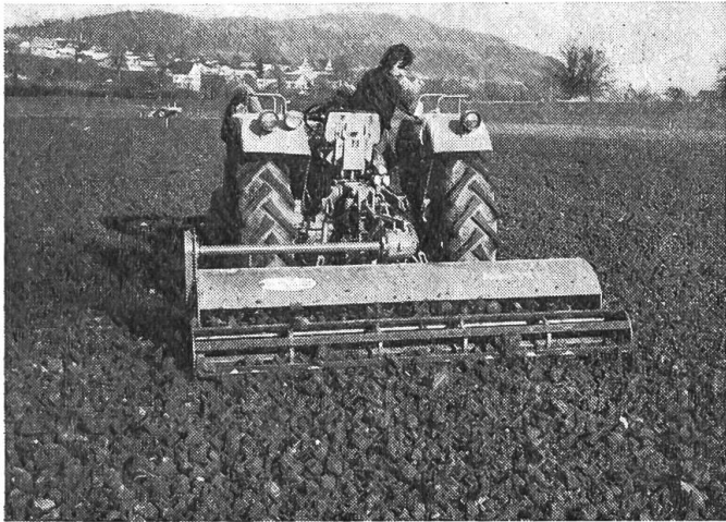
Fig. 11: Les pièces travaillantes de la herse à étoiles oscillantes ont un mouvement circulaire oscillatoire (dandinement) quand elles sont entraînées par la prise de force. Le travail effectué par cette machine permet d'accélérer le tassement d'une terre fraîchement labourée.
