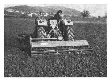
Fig. 11: Les pièces travaillantes de la herse à étoiles oscillantes ont un mouvement circulaire oscillatoire (dandinement) quand elles sont entraînées par la prise de force. Le travail effectué par cette machine permet d'accélérer le tassement d'une terre fraîchement labourée.
