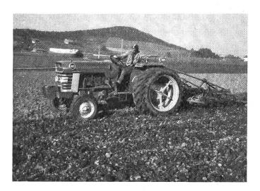
Fig. 7: Un vibroculteur (cultivateur à dents flexibles en acier plat) combiné avec un rouleau émotteur (émotteuse) représente actuellement l'un des ensembles de matériels qui sont le plus utilisés pour la préparation des lits des semences et des plants.
