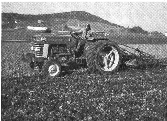
Fig. 7: Un vibroculteur (cultivateur à dents flexibles en acier plat) combiné avec un rouleau émoteur (émotteuse) représente actuellement l'un des ensembles de matériels qui sont le plus utilisés pour la préparation des lits des semences et des plants.
