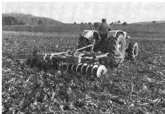
Fig. 8: Le pulvérisateur à disques continue à jouer un rôle de premier plan pour la préparation mécanique du sol (exécution des façons superficielles).
