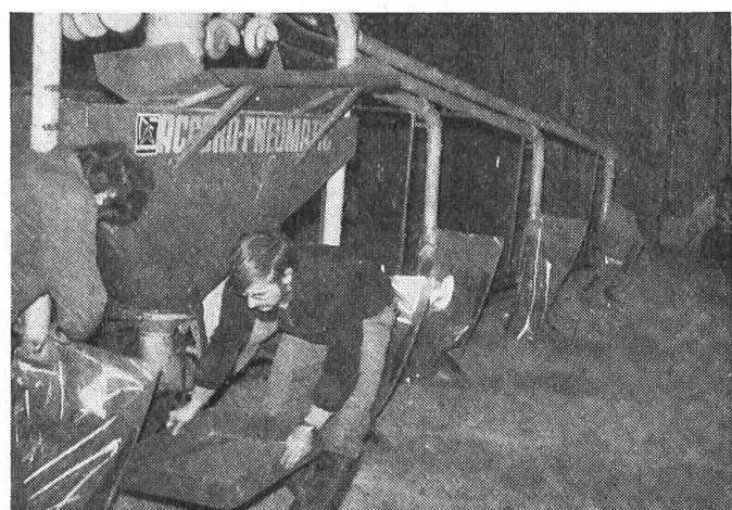
Fig. 3: Contrôle de la répartition de l'engrais aux tuyères d'épandage
