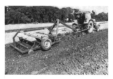
Aspect de la nouvelle combinaison de matériels (charrue, émotteuse, semoir) qui offre la possibilité de réaliser des économies de travail en effectuant en un seul passage le labour, l'émiettement de la terre et l'emblavage.
