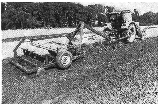
Aspect de la nouvelle combinaison de matériels (charrue, émotteuse, semoir) qui offre la possibilité de réaliser des économies de travail en effectuant en un seul passage le labour, l'émettement de la terre et l'emblavage.
