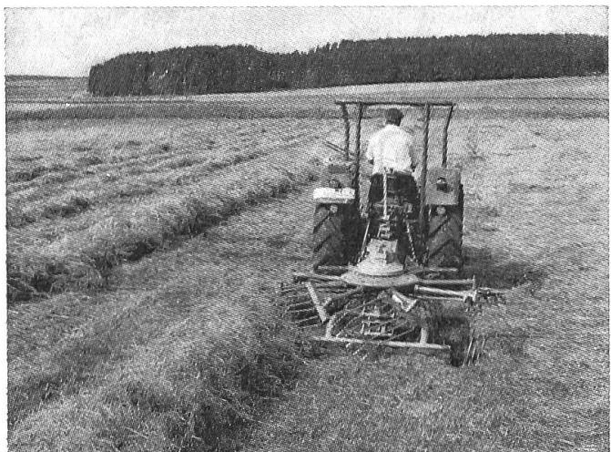
La nouvelle andaineuse rotative Fahr à double système de commande des râteaux qui peut être obtenue comme machine tractée ou portée.
