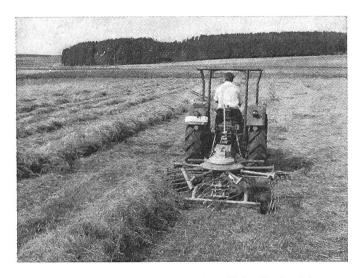
La nouvelle andaineuse rotative Fahr à double système de commande des râteaux qui peut être obtenue comme machine tractée ou portée.
