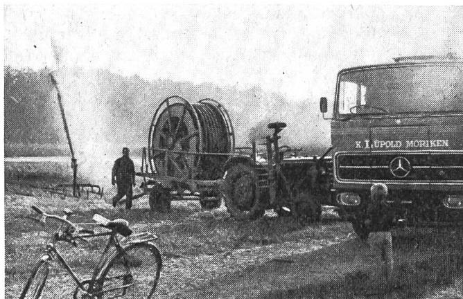
Fig. 5: La prise de force du tracteur assure la rotation du dévidoir — enroulement du tuyau souple — et, de ce fait, également le déplacement du petit traîneau qui porte le projecteur de lisier. Le dispositif électromécanique d'entraînement peut être aussi actionné par batterie.
