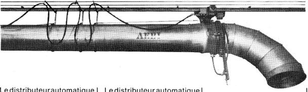
Le distributeur automatique Fe-Gu commandé par moteur électrique. Pour tuyauteries de 400 et 500 mm Ø. Surface de déchargement jusqu'à 7.00 m de profondeur et 12.00 m de largeur.
