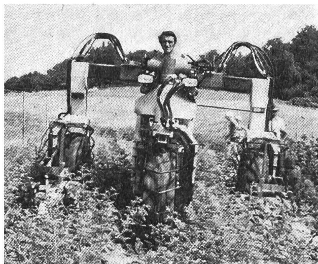
Fig. 1: Le nouveau tracteur enjambeur Hydro-Storch vu de côté.
