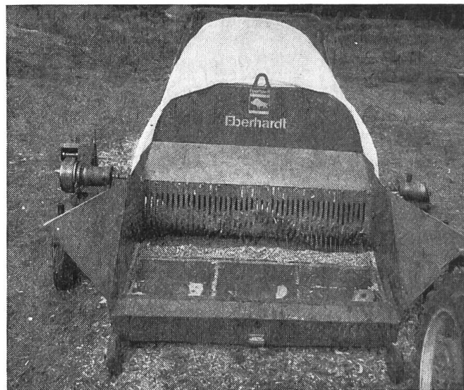
Fig. 3: La presse à ensiler Eberhardt est entraînée par la prise de force du tracteur. Elle refoule le fourrage haché, en le comprimant, dans un boyau en feuilles de plastique (silo-saucisson) qui sera ensuite hermétiquement fermé et conservera le produit à l'abri de l'air. L'arrière du boyau s'appuie sur un cadre avec filet qui est solidement ancré au sol et retenu par deux câbles. Ceux-ci s'enroulent sur deux treuils freinés montés de part et d'autre de la presse à ensiler.
