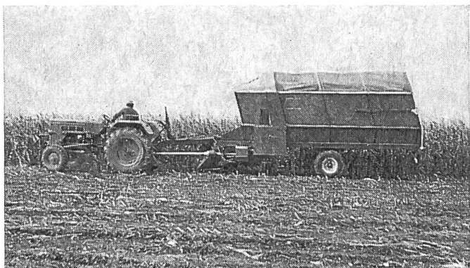
Fig. 2: La remorque chargeuse-hacheuse-déchargeuse Landsberg est un véhicule qui effectue à lui seul le ramassage-chargement, le hachage, le transport et le déchargement des fourrages. Lors de cette dernière opération, le dispositif hacheur fait office de transporteur semi-pneumatique. Deux tambours régulateurs d'admission assurent l'alimentation continue et dosée du disque ou tambour hacheur. Etant donné que le poids à vide de cette remorque est important et sa charge utile relativement faible, elle ne peut être mise économiquement en œuvre que dans des exploitations d'un seul tenant et à terrains plats.
