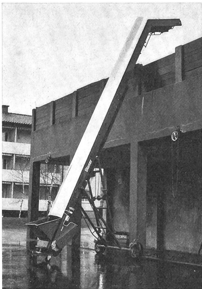
Fig.1: Aspect de l'élévateur mécanique «Blaser» avec ruban de très forte inclinaison (72°) et trémie d'alimentation qu'il est possible d'utiliser pour le transport en hauteur de produits en vrac.
