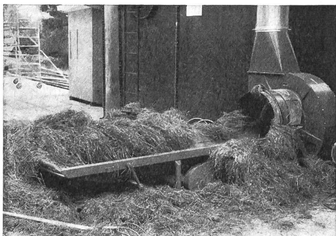
Fig. 4: L'emploi d'un dispositif doseur dit régulateur d'alimentation avec le transporteur pneumatique polyvalent permettrait d'éviter le ramassage du fourrage tombé, qui fait perdre du temps.
