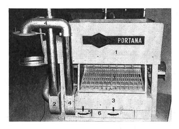
Un tamis à secousses (1) réalise le démêlage du foin. Les poussières sont aspirées par un ventilateur (2), tandis qu'une séparation des éléments de faible longueur a lieu dans la partie inférieure de la machine (3). Il s'agit des fleurs de foin (4), des grosses particules de terre et des corps étrangers (5), ainsi que des fines particules de terre et des graines (6). Prix de l'apprêteuse de foin en automne 1972: Fr. 3900.—. (sans câble ni fiche).
