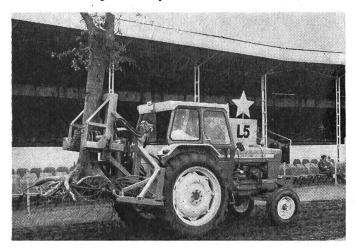
Un déterreur ou extracteur hydraulique de troncs d'arbre ayant une circonférence maximale allant de 90 cm à 1 m 15 était exposé à un stand de la Royal Show de 1972. Cette machine, appelée Hydrastumper, a été conçue et construite par une fabrique anglaise. L'inventeur de ce nouveau matériel s'est vu décerner une médaille d'argent à l'exposition agricole dont il s'agit.
