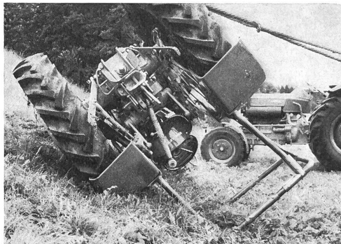
Tracteur qui a capoté latéralement et dont le cadre de sécurité ne présente pas ou peu de déformations.
