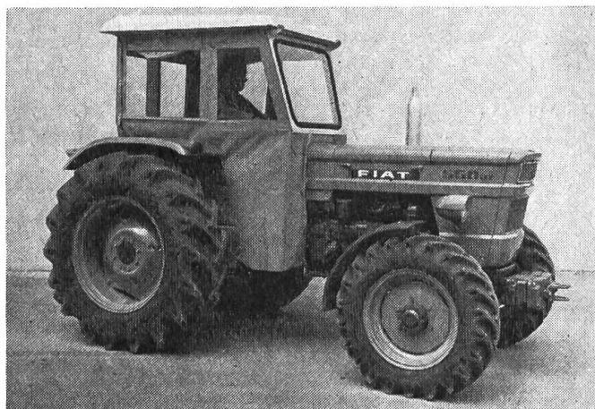
Cadre de sécurité muni d'un toit et d'un pare-brise relevable (en haut). — On peut aussi l'équiper de panneaux pour en faire une cabine de sécurité.
