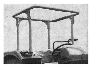
Aspect d'un cadre de sécurité. — Il est assujetti à quatre montants eux-mêmes fixés sur des gardeboue renforcés.
