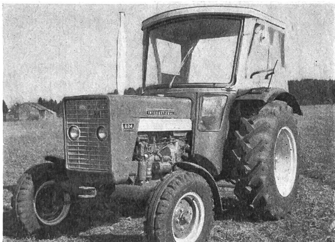
Cadre de sécurité pourvu d'un abri protégeant le conducteur contre les intempéries. — On peut accéder au siège par l'avant.
