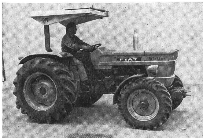
Cabine de sécurité offrant une visibilité totale. — Elle est pourvue de panneaux latéraux ouvrants.
