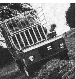
Poids à vide, sans conducteur: avec 1450 kg d'herbe avant 1100 kg 43 % 1405 kg 35 % arrière 1460 kg 57 % 2605 kg 65 % total 2560 kg 100 % 4010 kg 100 %
