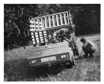
Fig. 2: Mesurage de la dérive (glissement transversal des roues) sur un terrain mouillé accusant un taux d'inclinaison de 30%.
