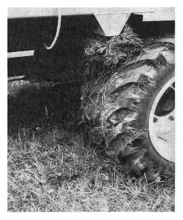
Fig. 1: Le petit accessoire que représente un racloir permet de débarrasser les roues jumélées de la terre et de la boue adhérentes. Si l'on fixe le racloir devant les roues, comme on le voit ici, la saleté qui tombe se colle à nouveau aux pneus pendant la marche.
