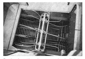
En plus du système de secouage longitudinal traditionnel, les nouvelles moissonneuses-batteuses John Deere sont équipées d'un dispositif de secouage transversal. Ce dispositif est placé au-dessus des éléments secoueurs ordinaires. Il agite une nouvelle fois, de gauche à droite et vice versa, la masse de paille qui sort du contre-batteur. La récupération supplémentaire de grain obtenue de cette façon correspond à une augmentation d'environ 25 % de la surface de secouage.
