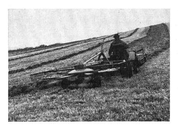
Fig. 6: La faucheuse autotractée Rapid à grand travail andainant le fourrage par pluie battante avec une andaineuse à une seule toupie. Ce fourrage sera déshydraté dans un séchoir à herbe.
