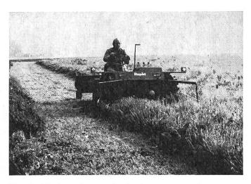
Fig. 3: L'«Heureka» exécutant en un seul passage, durant une période de mauvais temps, le fauchage et la mise en andains d'un fourrage lourd destiné à l'ensilage. Ce produit mouillé sera immédiatement repris par une ramasseuse-hacheuse-chargeuse puis mis en silo sans plus attendre.
