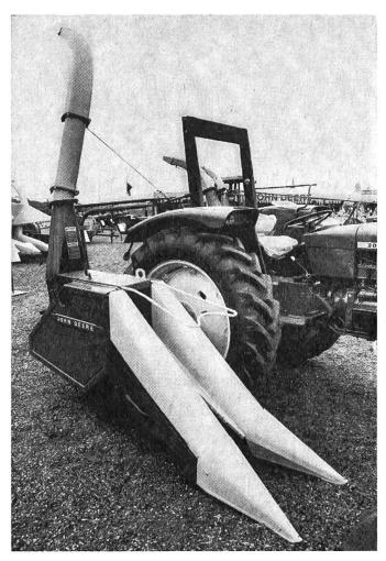
Sur les nouvelles récolteuses de maïs portées John Deere (faucheuses-hacheuses-chargeuses), la longueur de coupe peut être réglée avec une extrême précision (jusqu'à 3 mm) grâce à un changement de pignons. La capacité de travail de ces machines représente de 25 à 30 tonnes à l'heure.
