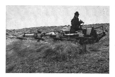
Fig. 5: Une épandeuse-faneuse portée à toupies multiples, d'une largeur de travail de 3 m 60, a été accouplée ici à la faucheuse «Heureka». Cette faneuse permet d'exécuter toutes les opérations de la fenaison. En lieu et place de ce matériel, on peut aussi utiliser la machine combinée Rapid ou bien une andaineuse à toupie unique, un râteau faneurandaineur, etc.
