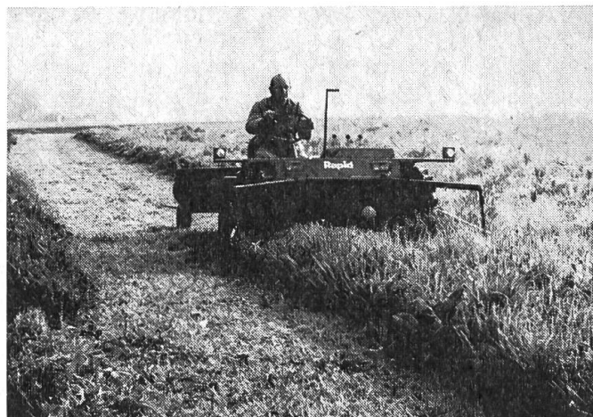
Fig. 3: L'«Heureka» exécutant en un seul passage, durant une période de mauvais temps, le fauchage et la mise en andains d'un fourrage lourd destiné à l'ensilage. Ce produit mouillé sera immédiatement repris par une ramasseuse-hacheuse-chargeuse puis mis en silo sans plus attendre.
