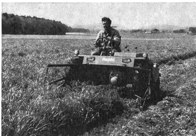
Fig. 1: A une vitesse d'avancement pouvant aller jusqu'à 10 km/h, et avec une largeur de travail de 2 m, cette faucheuse autotractée Rapid arrive à récolter de très importantes superficies à l'heure. Le fourrage est peu souillé et la couche herbeuse largement ménagée.
