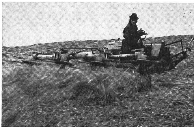
Fig. 5: Une épandeur-faneuse portée à toupies multiples, d'une largeur de travail de 3 m 60, a été accouplée ici à la faucheuse «Heureka». Cette faneuse permet d'exécuter toutes les opérations de la fénaison. En lieu et place de ce matériel, on peut aussi utiliser la machine combinée Rapid ou bien une andaineuse à toupie unique, un râteau faneur-andaineur, etc.
