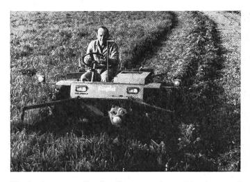
Fig. 2: La nouvelle faucheuse autotractée à grand travail effectuant simultanément la coupe et l'andainage de l'herbe. Selon le genre et la densité du fourrage, on peut engager la deuxième ou la troisième vitesse.
