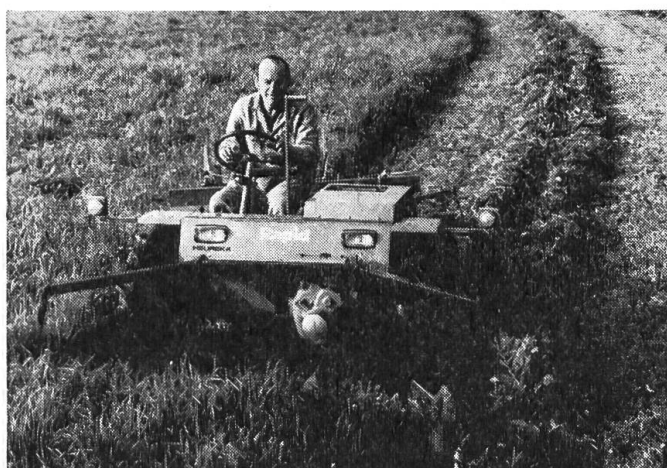
Fig. 2: La nouvelle faucheuse autotractée à grand travail effectuant simultanément la coupe et l'andainage de l'herbe. Selon le genre et la densité du fourrage, on peut engager la deuxième ou la troisième vitesse.
