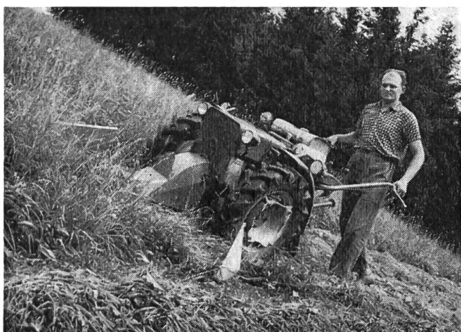
Fig. 3: La machine représentée ici n'est pas à proprement parler une motofaucheuse, mais un tracteur à deux roues que l'on a pourvu d'une barre de coupe de 1 m 90.
