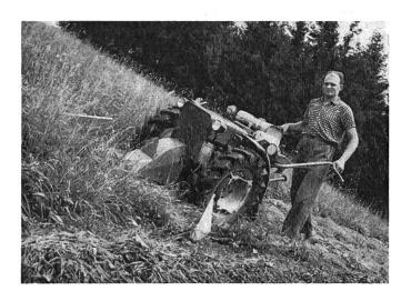
Fig. 3: La machine représentée ici n'est pas à proprement parler une motofaucheuse, mais un tracteur à deux roues que l'on a pourvu d'une barre de coupe de 1 m 90.
