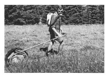
Fig. 4: De la propagande a été également faite auprès des paysans de montagne au sujet de cette moto-faucheuse monoroue. Etant donné la faible surface qu'on arrive à récolter à l'heure avec elle et aussi l'insuffisance de ses aptitudes pour un emploi sur les terrains en pente, elle ne peut pas entrer en considération. Son conducteur a été équipé ici d'un appareil destiné à mesurer l'énergie qu'il lui faut dépenser pour faucher avec cette machine.
