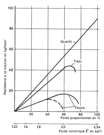
Fig. 6: Résistance à la traction de matières plastiques armées de verre en fonction du mode de renforçage et de la teneur en fibres de verre.
