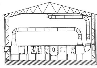
Fig. 2a: Vue en coupe de l'installation montrant l'appareillage de climatisation.
