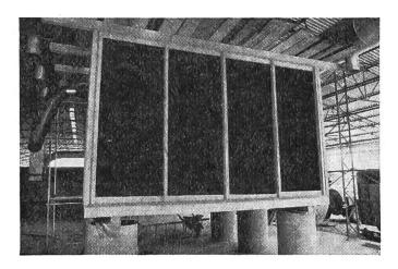
Fig. 4: Vue en coupe de l'installation montrant le modèle à mettre à l'épreuve.
