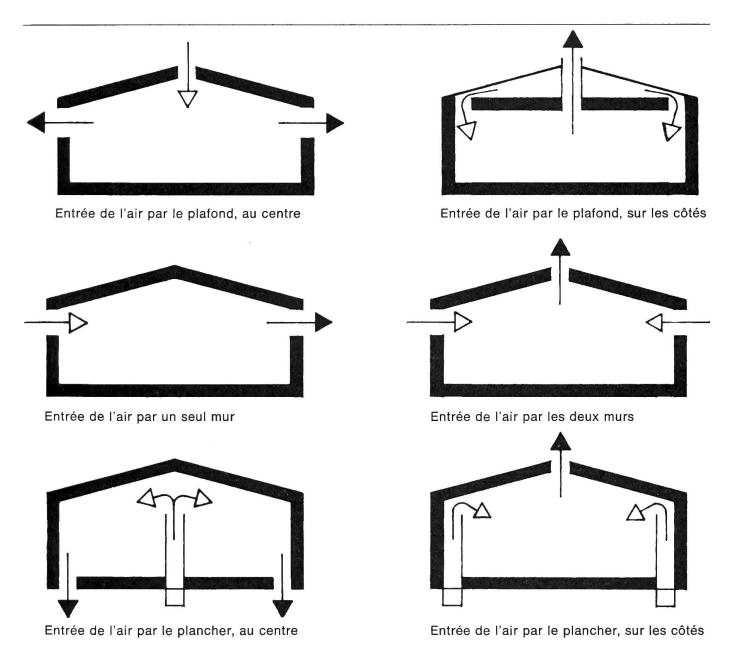
Fig. 1: Les différentes possibilités offertes pour la disposition des ouvertures d'entrée d'air frais dans les étables en vue de leur ventilation mécanique.
