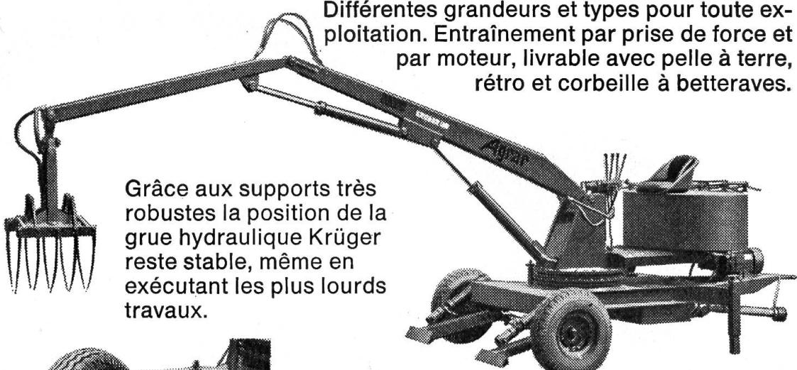
Grâce aux supports très robustes la position de la grue hydraulique Krüger reste stable, même en exécutant les plus lourds travaux.
