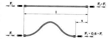
Fig. 3: Rendement d'un câble de frein de remorque.
