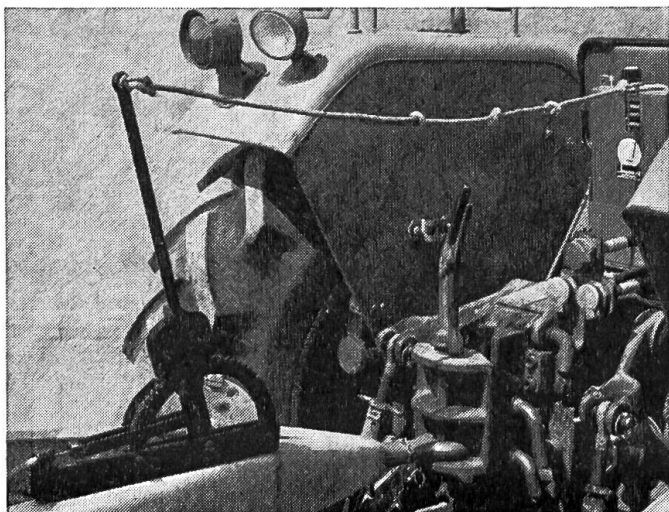
Fig. 2: Levier de commande de frein de remorque qu'on actionne au moyen d'un câble. — Il suffit de tirer ce dernier pour serrer le frein. Une brève traction exercée ultérieurement sur le câble permet de desserrer le frein.
