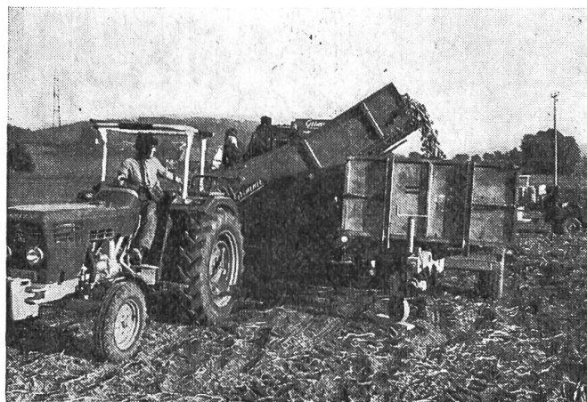
Fig. 6: Machine effectuant la récolte totale des pommes de terre dont la trémie collectrice comporte une paroi roulante faisant fonction d'élévateur (chargement d'une remorque à caisse).
