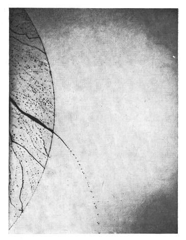
Fig. 2: Cette photo, prise avec un temps d'exposition de 1 millionième de seconde, montre comment un filet de liquide phytosanitaire projeté par le disque rotatif se divise en gouttelettes microscopiques de même grosseur.
