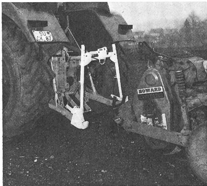
Fig. 3: Processus d'accouplement rapide, au système d'attelage trois-points, d'un matériel de travail semi-porté à entraînement par prise de force.
