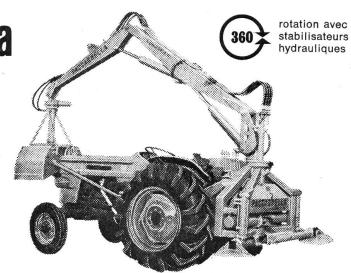
Puissance de levage à bras tendu: 450 kg - 600 kg - 1100 kg Accessoires: rétro, bennes à terre et betteraves, griffe à fumier; commande hydraulique pour chaque accessoire.
