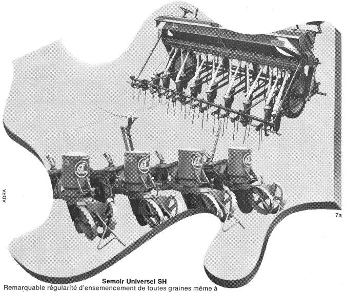
Remarquable régularité d'ensemencement de toutes graines même à 15 km/h. — Attelage semi-automatique permettant une certaine autonomie par rapport au tracteur. — Descente en deux temps des socs avec griffes basculantes. — Réglage individuel et central de la pénétration. — Tubes téléscopiques translucides d'une robustesse exceptionnelle. — Trémie à grande capacité, à couvercle basculant.
