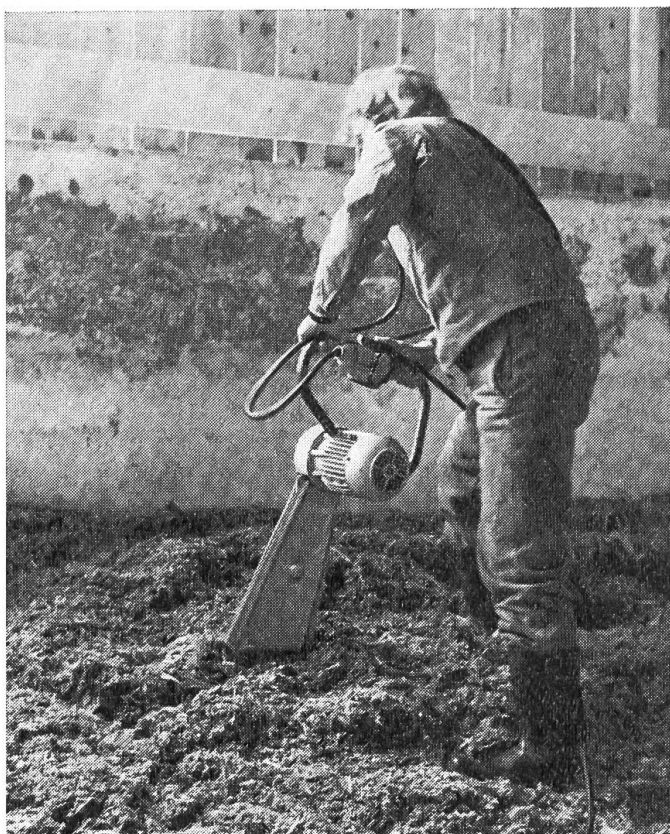
Fig. 4: Utilisation du coupe-silage SCHNEIDFIX. Organe de tranchage: petite barre de coupe à double lame. Il est indiqué de porter le câble électrique sur l'épaule. Prix de ce modèle: Fr. 1640.—.
