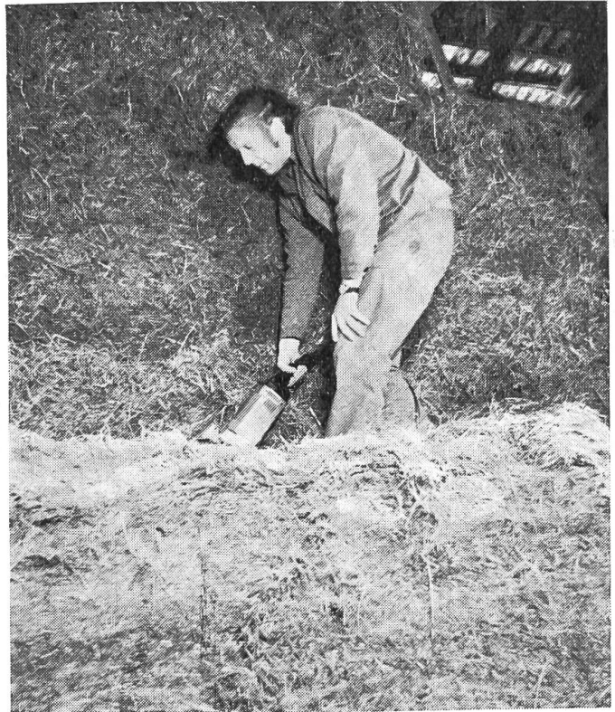
Fig. 3: Emploi du coupe-foin mécanique ZIP. Le tranchage du fourrage à la machine ne demande pas de grands efforts physiques.
