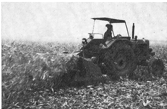
Fig. 10: Hacheur-broyeur de paille à prise de force mis en œuvre sur un champ de maïs-grain après la récolte.
