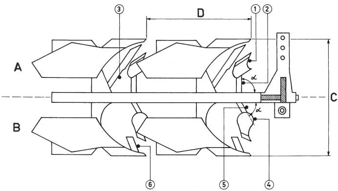
Fig. 9: Charrue portée bisoc partiellement munie de l'équipement traditionnel (A) et de l'équipement spécial pour l'enfouissage de la paille de maïs (B).
