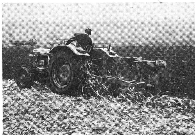
Fig. 11: Enfouissage à la charrue de paille de maïs tronçonnée.
