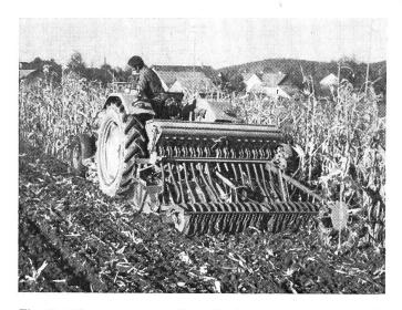
Fig. 2: Mise en œuvre d'une fraiseuse-semeuse après la récolte du maïs-grain. La préparation du sol et l'emblavage se font en un seul passage.
