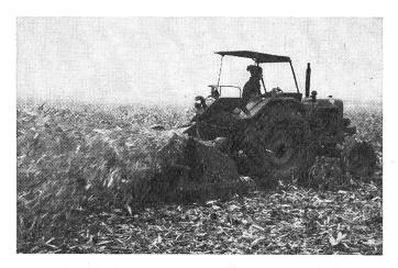
Fig. 10: Hacheur-broyeur de paille à prise de force mis en œuvre sur un champ de maïs-grain après la récolte
