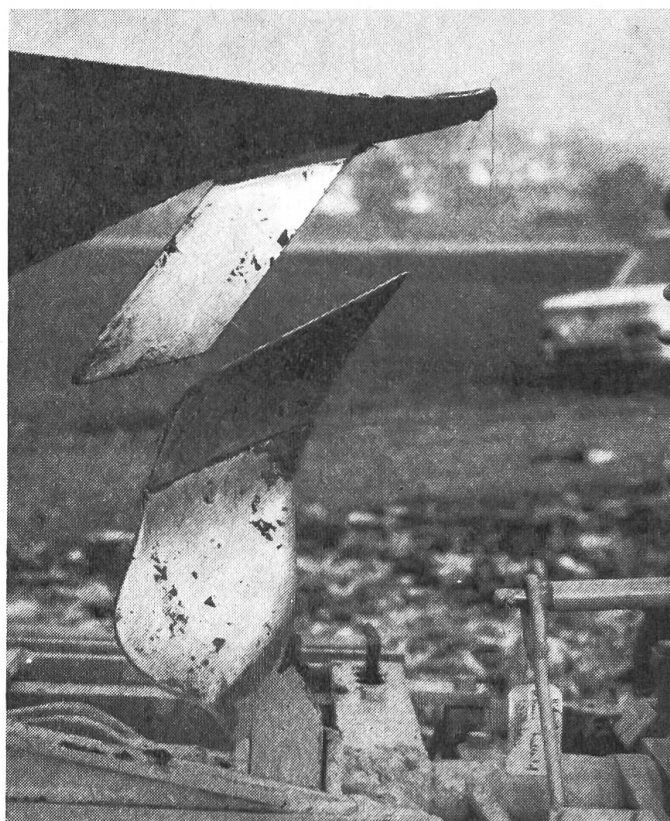
Fig. 8: Coutre court de type spécial fixé sur le soc.
