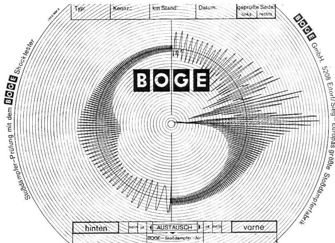
Ce diagramme a été obtenu avec l'appareil spécial Boge «Shocktester» prévu pour le contrôle de l'état des amortisseurs d'oscillations des voitures automobiles. Il montre le comportement de deux amortisseurs de modèle identique. Les oscillations de celui de gauche sont normales et l'efficacité de cet appareil est de 100% (amortisseur en bon état). A droite, il s'agit d'un amortisseur usé et défectueux dont l'efficacité se trouve réduite de 50%.
