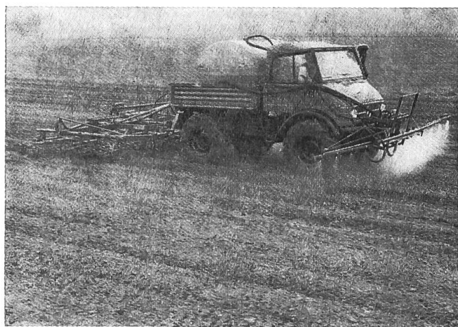
Fig. 1: L'Unimog 84/406 L est un véhicule de traction et de transport que l'on utilise beaucoup dans les grandes exploitations agricoles allemandes. Les matériels combinés qui sont accouplés à l'arrière et servent à préparer les lits de germination ont une largeur de travail de 4 m 40.
