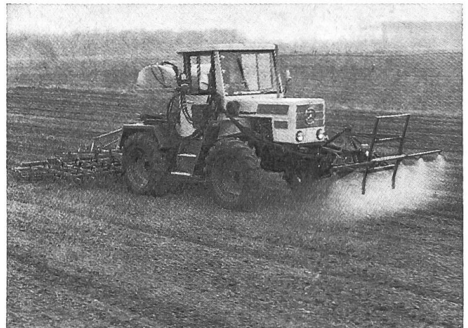
Fig. 3: Cette combinaison de matériels pour la préparation des lits de germination (les parties extérieures peuvent être repliées hydrauliquement pour circuler sur les routes) a une largeur d'action de 3 m 30. La barre de traitement montée à l'avant est adaptée à cette largeur de travail.
