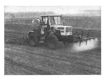
Fig. 3: Cette combinaison de matériels pour la préparation des lits de germination (les parties extérieures peuvent être repliées hydrauliquement pour circuler sur les routes) a une largeur d'action de 3 m 30. La barre de traitement montée à l'avant est adaptée à cette largeur de travail.
