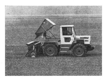
Fig. 4: Le semoir représenté ici peut emblaver une bande de terre d'une largeur allant jusqu'à 3 m. Combiné avec une trémie basculante d'une contenance de 1500 litres, il peut travailler de 5 à 10 hectares pratiquement sans occasionner d'interruptions pour son réapprovisionnement.
