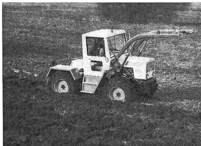
Fig. 2: Le MB Trac 65/70 est une véritable machine à quatre roues motrices puisque ces roues ont le même diamètre. Elle comporte en outre un système de blocage du différentiel dans chaque essieu. Par ailleurs, la judicieuse répartition des poids assure la transmission intégrale de la force motrice au sol.
