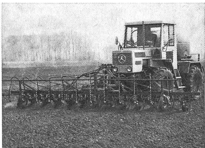
Fig. 5: Cette sarceleuse accouplée à l'avant du MB Trac 65/70 donne la possibilité de travailler simultanément 12 rangées séparées par un interligne de 45 cm. Elle a été complétée par un pulvérisateur qui assure le traitement des plantes également sous le feuillage.
