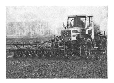
Fig. 5: Cette sarcleuse accouplée à l'avant du MB Trac 65/70 donne la possibilité de travailler simultanément 12 rangées séparées par un interligne de 45 cm. Elle a été complétée par un pulvérisateur qui assure le traitement des plantes également sous le feuillage.
