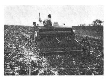
Fig. 8: Emploi simultané d'une fraise à lames et d'un semoir porté sur un champ où l'on vient de récolter du maïs-grain. La mise en terre des graines a lieu derrière la fraise. Il faut un tracteur d'une puissance atteignant jusqu'à 100 ch avec une fraise à lames d'une largeur de travail de 2 m 50.
