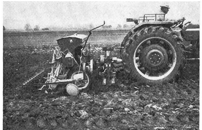
Fig. 2: Ameublissement et ensemencement simultanés sur un champ préalablement labouré. Cette combinaison de matériels comprend une herse oscillante (barres porte-dents transversales animées d'un mouvement de va-et-vient) et un semoir en lignes. Le champ est ameubli et emblavé en un seul passage!
