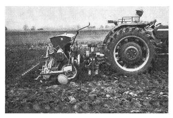
Fig. 2: Ameublissement et ensemencement simultanés sur un champ préalablement labouré. Cette combinaison de matériels comprend une herse oscillante (barres porte-dents transversales animées d'un mouvement de va-et-vient) et un semoir en lignes. Le champ est ameubli et emblavé en un seul passage!
