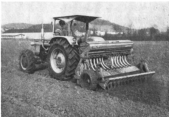
Fig. 7: La combinaison de matériels qui se compose d'une fraise à lames et d'un semoir porté peut être considérée aujourd'hui comme la solution la plus polyvalente pour la préparation minimale du sol. Elle permet en effet d'exécuter des semis en lignes, en bandes ou à la volée aussi bien sur des sols non labourés que sur des sols préalablement travaillés avec la charrue.
