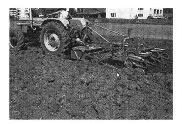
Fig. 5: Combinaison de matériels constituée d'une fraise à lames, d'un rouleau émotteur et d'un semoir monograine à plusieurs éléments. Un matériel combiné de ce genre exige une grande puissance d'entraînement à la prise de force et surtout un dispositif de relevage hydraulique de construction extra-solide.
