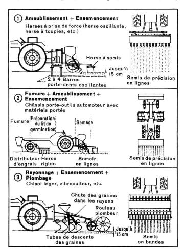
Fig. 1: Ces combinaisons de matériels pour la préparation du sol en un seul passage sont décrites dans le présent article.
