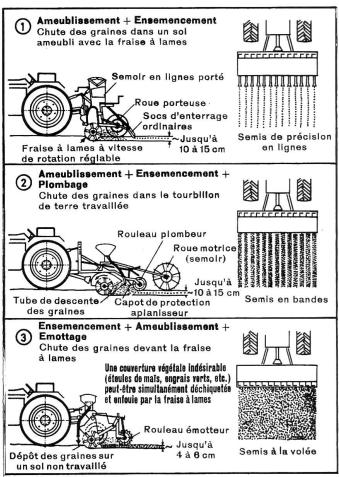
Fig. 6: Ces combinaisons de matériels pour la préparation du sol en un seul passage sont décrites dans le présent article.
