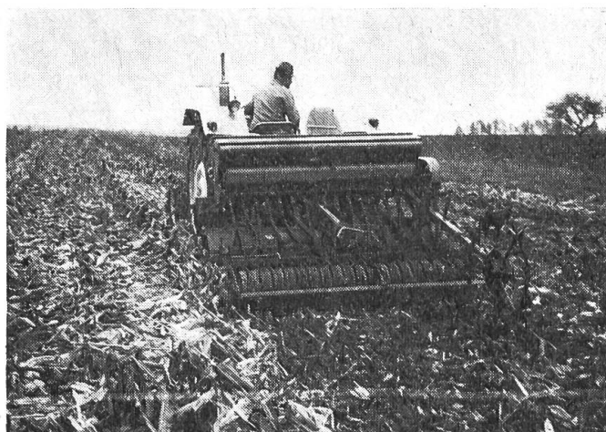
Fig. 8: Emploi simultané d'une fraise à lames et d'un semoir porté sur un champ où l'on vient de récolter du maïs-grain. La mise en terre des graines a lieu derrière la fraise. Il faut un tracteur d'une puissance atteignant jusqu'à 100 ch avec une fraise à lames d'une largeur de travail de 2 m 50.
