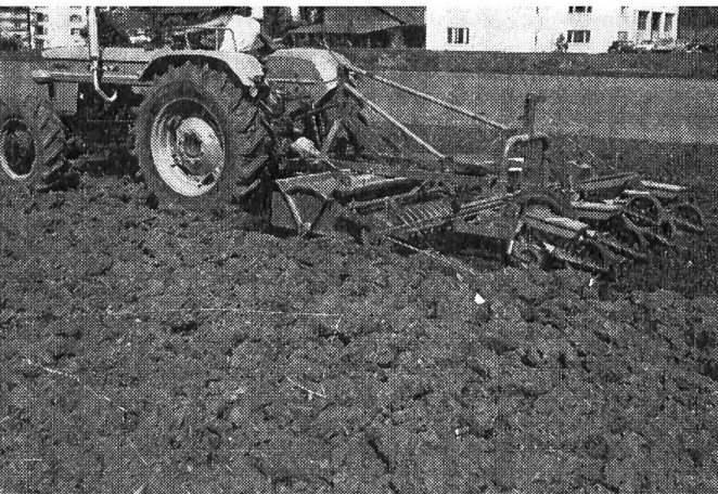
Fig. 5: Combinaison de matériels constituée d'une fraise à lames, d'un rouleau émoteur et d'un semoir monograin à plusieurs éléments. Un matériel combiné de ce genre exige une grande puissance d'entraînement à la prise de force et surtout un dispositif de relevage hydraulique de construction extra-solide.
