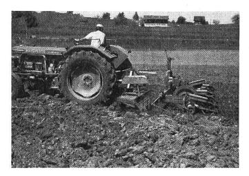
Fig. 4: Combinaison de matériels formée d'une herse à toupies et d'un semoir monograine à éléments multiples pour le maïs.
