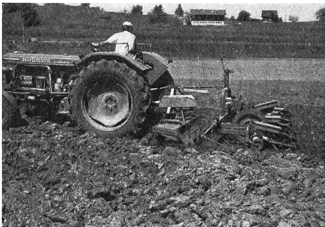
Fig. 4: Combinaison de matériels formée d'une herse à toupies et d'un semoir monograin à éléments multiples pour le maïs.
