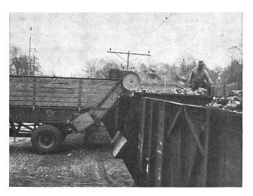
Fig. 5: Véhicule agricole à usages multiples employé pour le transbordement des betteraves sucrières sur le quai de chargement normal d'une station de chemin de fer.
