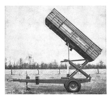
Fig. 4: Aspect d'une semi-remorque équipée d'une benne basculante relevable (benne transbordeuse).
