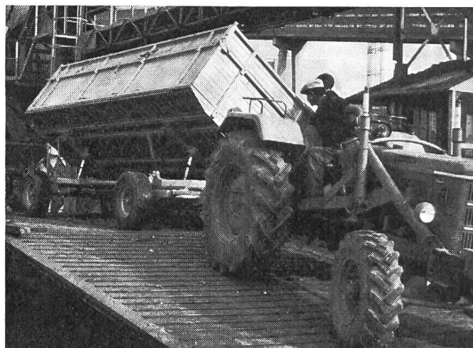
Fig. 1: Les remorques à caisse basculante permettent d'éviter éventuellement de longues attentes lorsque les betteraves sucrières sont livrées directement à la fabrique.
